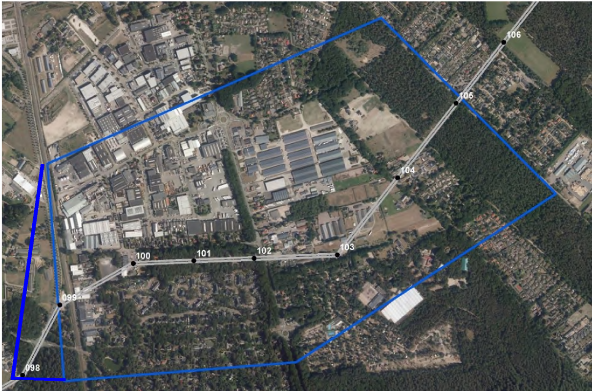
Figuur 3.1 | Zoekgebied verkabeling tussen mast 99 en mast 104 of mast 105
